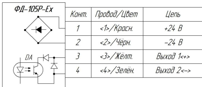
Рис. 2в. Назначение контактов клемной колодки ФД-105-Р-Ех.
