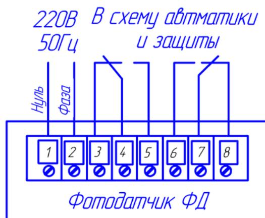
Рис. 2 Назначение контактов клеммной колодки
